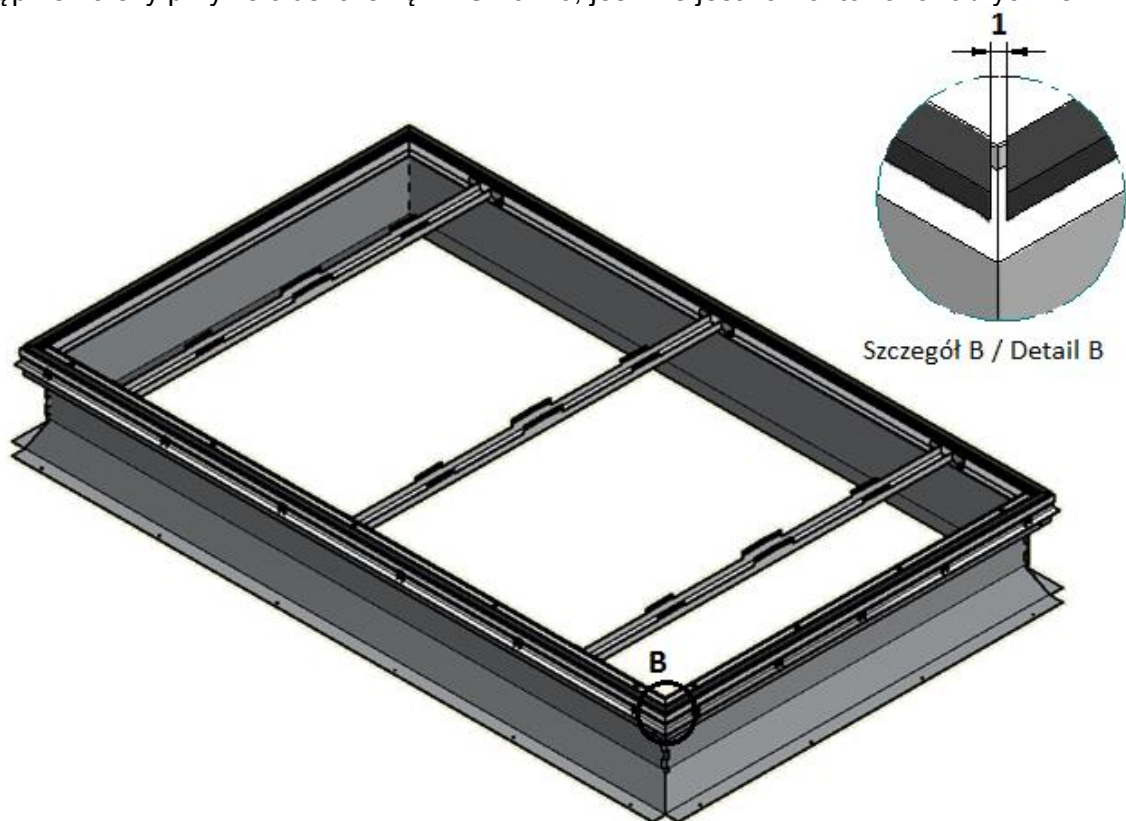
Rys. 45. Podstawa świetlika FIX z zainstalowanym wieńcem wyposażonym w trawersy i uszczelkę PES 20x10.
