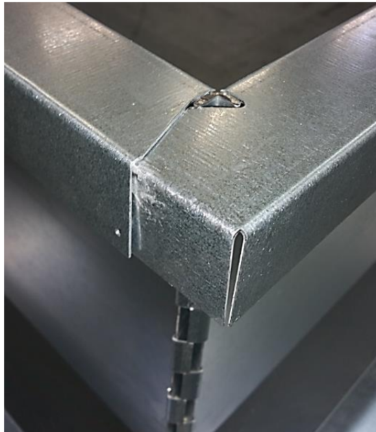
Rys. 25. Prawidłowo połączone ściany.
