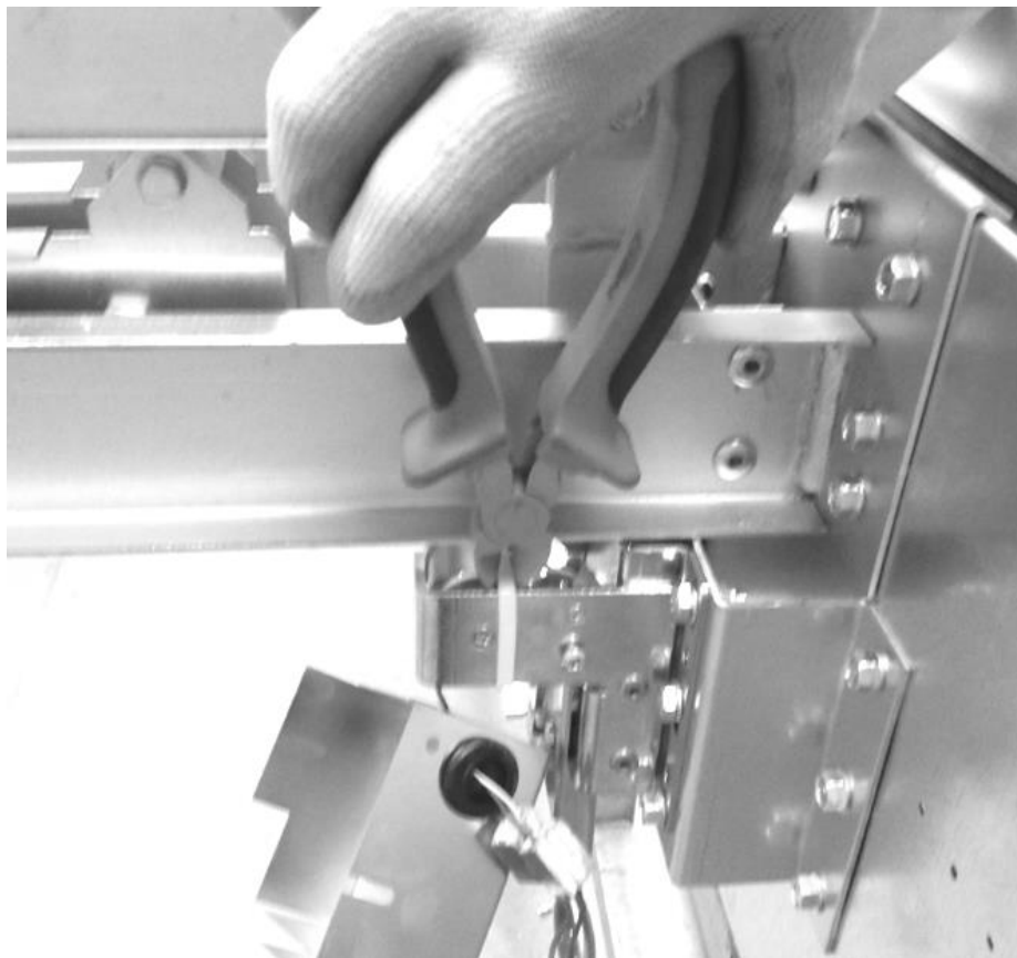
Rys. 37 Przycinanie opaski zaciskowej w celu odbezpieczenia zamka.
